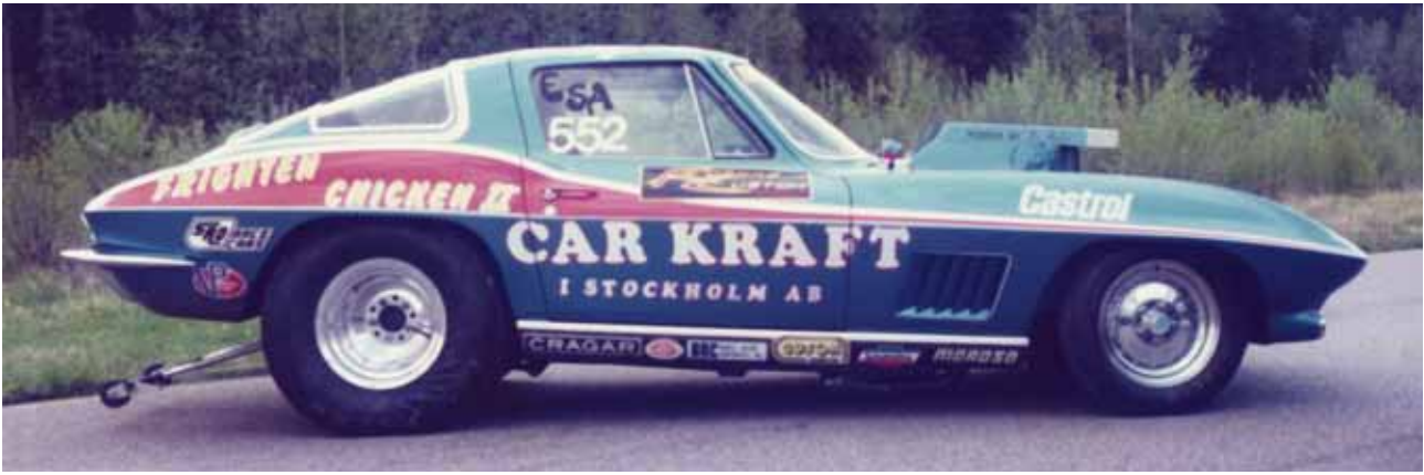
Den sista corvetten som skulle bli tävlingsbil importerades från USA. Det var en 1967 Big block coupe med Dana 60 bakaxel med manuell växellåda. Med den här Corvetten var Gunne åter på tronen igen i dragracingen. Det blev ett bästa ET (Elimination Time) på 9,82 sekunder. Den döptes till Frighten Chicken II eftersom de tidigare tävlingsbilarna hette Frighten Chicken och More Frighten
