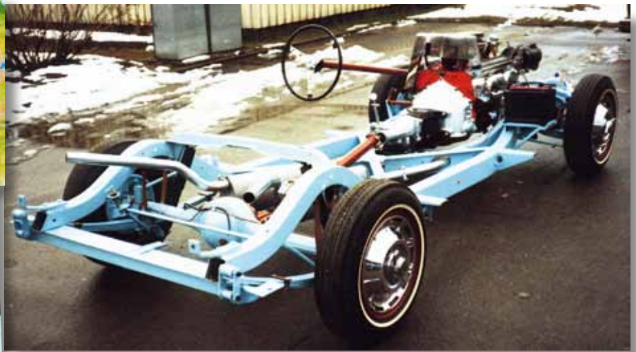
På den högra bilden ser vi det renoverade chassit med motor och drivlina monterad. Inge hade målat hela ramen i en ljusblå färg, som bl a användes för att måla utomhuspoler. Detta var före pulverlackeringen tid, då man fick finna andra lösningar. Rostskyddet med den här färgen är dock enormt bra, så den här ramen överlever alldeles säkert oss alla. Fast man måste väl ändå tycka att den här färgen skulle matcha Horizon Blue väldigt bra. Senare övermåladess ramen i svart.
