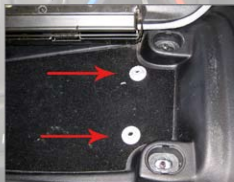
3 (bilderna ovan och nedan). Öppna mittkonsollen. I bakändan finns två ovala plastlock som täcker två 10 mm muttrar, som du lossar.
