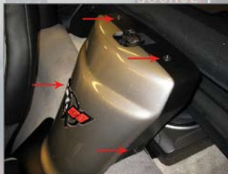
2. Tag bort vattenfallet genom att lossa 4 st T15 skruv (T = Torx), två på var sida. Fallet dras sedan rakt upp.
