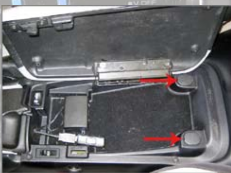
3 (bilderna ovan och nedan). Öppna mittkonsollen. I bakändan finns två ovala plastlock som täcker två 10 mm muttrar, som du lossar.
