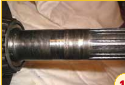
12. Skador på spindeln efter lagret, men jag nöjde mig med att putsa bort de värsta reporna. Är spindeln svårt skadad ska den bytas.
