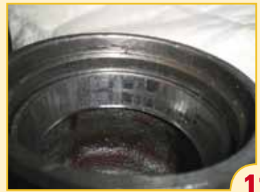
11. Här ser man hur den inre lagerbanan är skadad.
