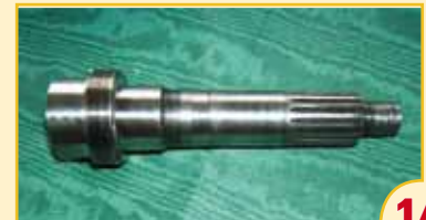
14. Inshimsningsverktyget är tillverkat av en gammal spindel, lagerdiametrarna är nerslipade några hundradelar så att det bli glidpassning. Utan det här verktyget går det inte att shimma in lagerpaketet.
