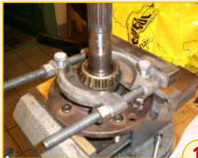
13. Avdragarverktyget för det yttre lagret på spindeln.
