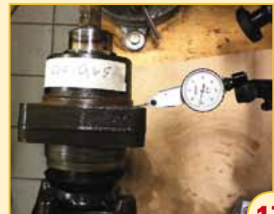
17. Vid provningen med shimsverktyget blev resultatet ett glapp på ca 0,65 mm vilket ju är extremt mycket. Indikatorerklockan bottnade nästan! Det visade sig att de nya lagren ej var lika breda som original lagren.
