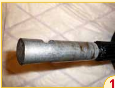
10. "Spindle knocker" verktyget, används för att slå ur spindeln från support.
