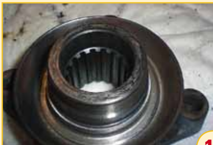
15. Det är också klokt att man inspekterar "flangen" så att den är i bra skick. Så här såg anläggningsytan som pressar på lagrets ytterring ut. Är den mer skadad än på bilden bör den planslipas annars är det risk att lagret kårar sig in i metallen och shimsavståndet kommer på sikt att växa.
