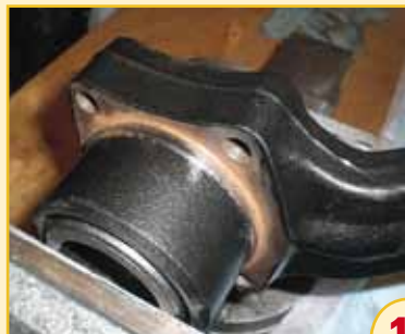
16. När lagerhalvorna skall pressas i support värmdes support till +100 grader och lagerhalvorna kylde ner till -20 grader i fryboxen. Sedan var det bara att släppa ner lagerbanorna och pressa ihop dem. För att pressa användes de gamla lagerhalvorna, som smärglats av några tiondelar så att de inte skulle fastna i support.
